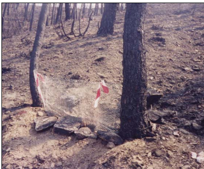
Photo 3 - Piège à sédiments mis en place dans le massif des Maures pour l'étude des matériaux mobilisés.
