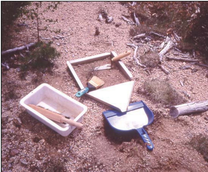
Photo 1 - Cadre pour prélèvement utilisé pour l'étude du pavage dans le bois de l'Altefage en Lozère.
